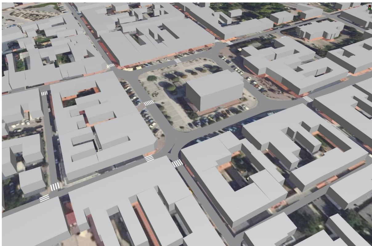
Rys. 4.3. Mikrosymulacyjny model ruchu w programie Vissim, widok 3D
