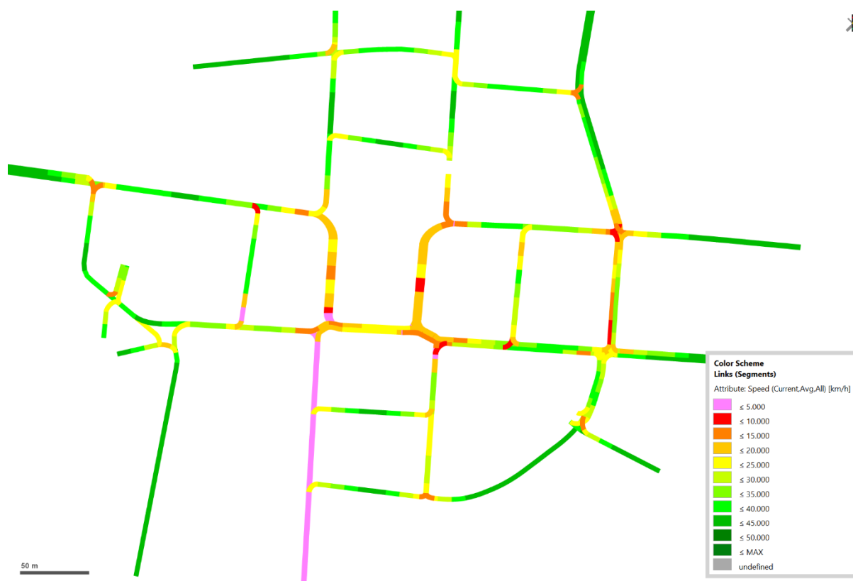
Rys. 4.15. Średnie prędkości pojazdów [km/godz.], wariant W2b
