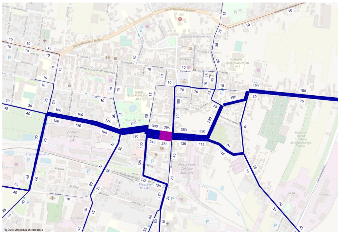
Rys. 3.20. Rozkład przestrzenny ruchu z ul. Kaczyńskiego, rok 2025, godzina szczytu popołudniowego, wariant W1a [poj./godz.] – widoczny ruch tranzytowy odbywający się ciągiem Wodna – Krzywa – Stolarska – Wyspiańskiego – Kaczyńskiego – Słowackiego.
