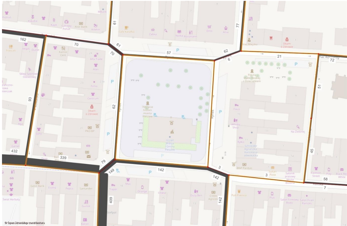
Rys. 5.7. Rozkład ruchu pojazdów w roku 2025 - godzina szczytu popołudniowego, wariant rekomendowany - W6B, zbliżenie obszaru Rynku [poj./godz.]
